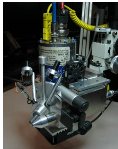
Sistema de Fluorescencia de Rayos X SANDRA, IFUNAM
