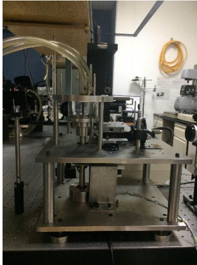
Figura 3.4. Geometría de cilindros concéntricos transparente diseñado por Arenas, B. & Castillo. El motor se encuentra anclado al cilindro externo y el baño térmico está acoplado al cilindro interno como se observa en la Figura 3.5. La relación d/H = 0.439 \ll 1 por lo cual el flujo puede considerarse laminar.
