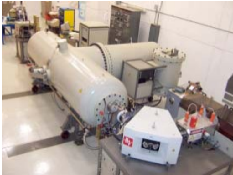
Acelerador van de Graeff de 12 MeV instalado en el Centro Nuclear de Salazar
