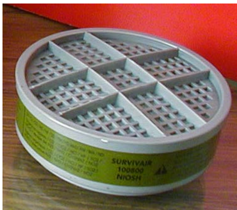
Figura 16. Mascara de filtro de aire comercial, que se puede usar como detector de radón, de carbón activado.
