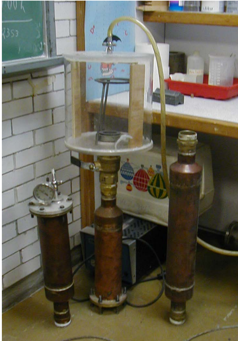
Figura 32.- Cámara de verificación de radón, del Proyecto de Aplicaciones de la Dosimetría del IFUNAM.
