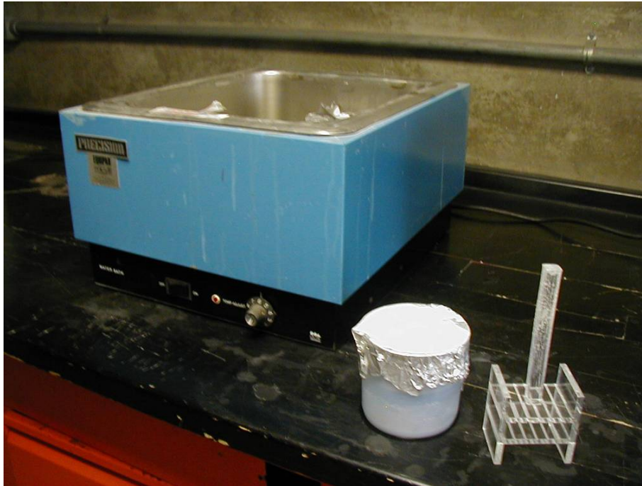
Figura 26. Sistema para el grabado químico de los detectores plásticos, y los dispositivos para su manejo.
