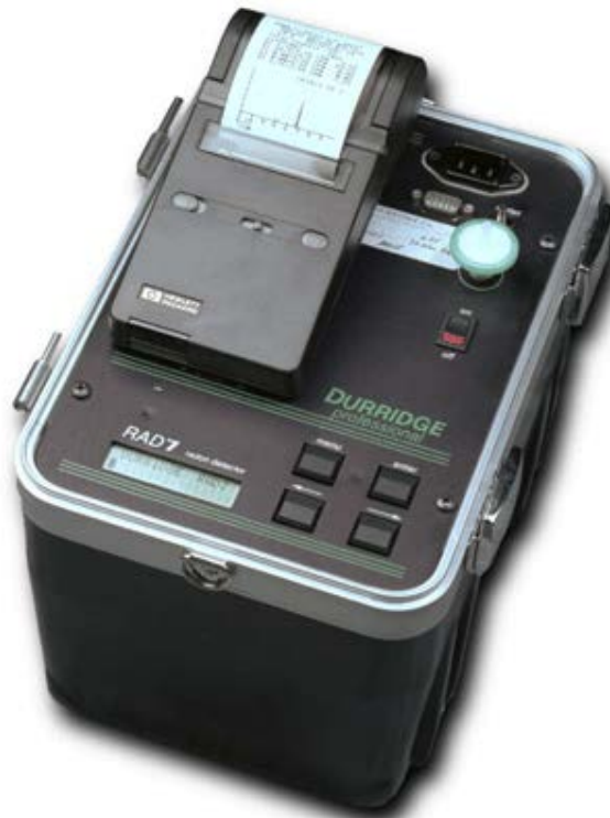
Figura 12.- Monitor de radón marca DurrIDGE, modelo Rad-7 ® .
