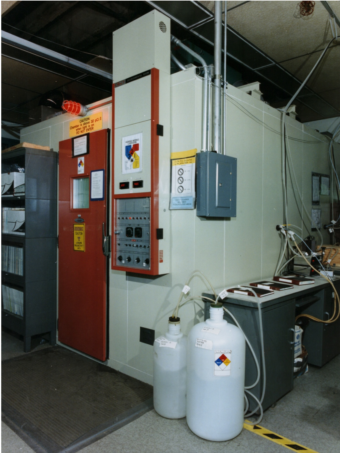
Fig. 31.- Cámara de calibración de radón del Oak Ridge National Laboratory.
