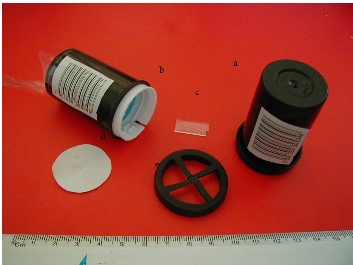
Figura 24. Vaso de portapelícula fotográfica, que consta de: a) volúmen sensible; b) porta detector (tapa de refresco); c) material sensible a la radiación; d) filtro; y e) tapa del volumen sensible, perforada.
