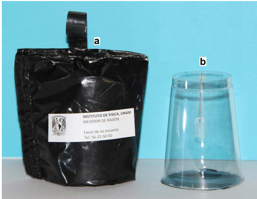
Figura 23.- Dispositivo para la medición de radón intramuros modificado para hacer mediciones de radón (a) y dispositivo sin bolsa de protección (b).
