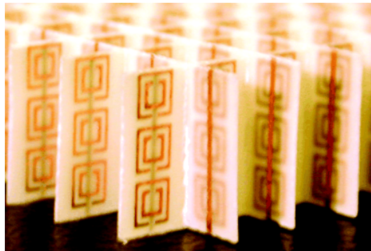
Figura 4.10: Un metamaterial bidimensional izquierdo en la región de microondas. Imagen tomada de [10].
