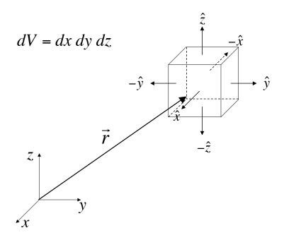
Figura 2: Elemento de volumen dV = dxdydz localizado en el punto  $\vec{r}$ . Se muestran los vectores normales a cada una de las caras del elemento.
