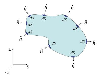
Figura 1: Cuerpo de forma arbitraria inmerso en un fluido o sólido con tensor de presiones dado  $\tilde{P}(\vec{r})$ . Se muestran unas cuantas diferenciales de área y sus normales correspondientes.
