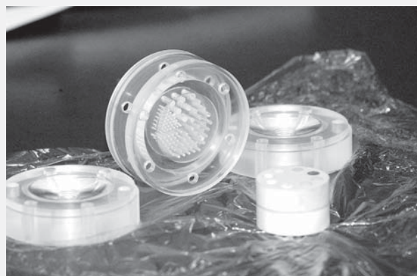
Maniqués de calibración para tomografía PET (transparente) y CT.
