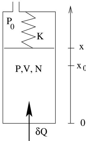
a) En la aproximación de procesos cuasi-estáticos, deducir de la condición de equilibrio del pistón una relación entre las variables  $P$  y  $V$ . Podemos notar  $V_0$  el volumen del gas cuando  $x = x_0$ .
