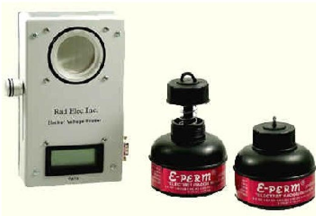
Figura II.5. Electret E-PERM ® y su cargador.
