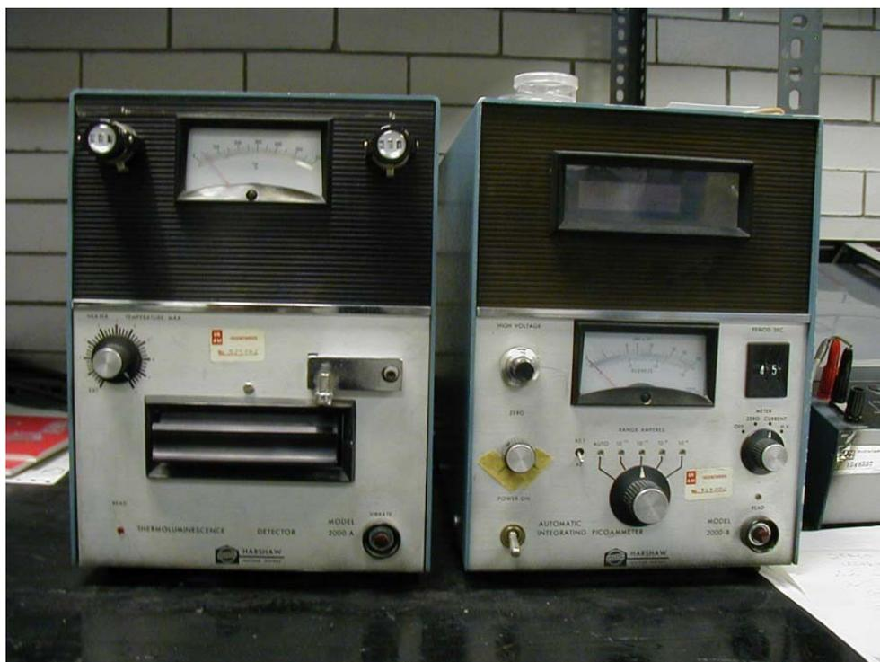
Figura II.4.- Equipo lector de Termoluminiscencia (Proyecto PAD-IFUNAM)
