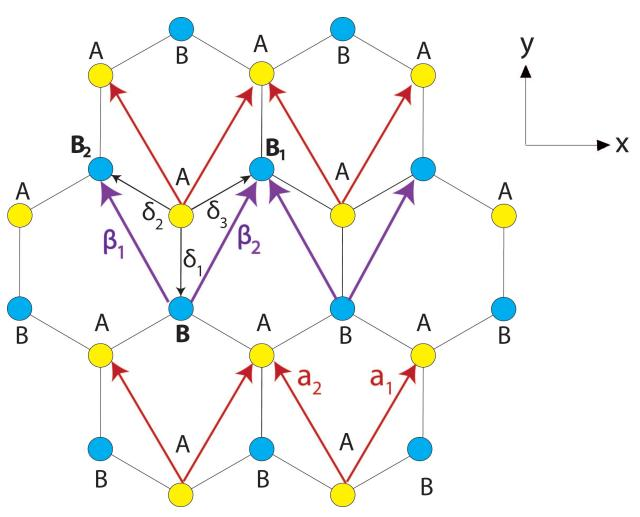
FIG. 2: Se muestran las dos subredes (morado y rojo) de las que se forma la red hexagonal debido a los dos tipos de átomos A (amarillo) y B (azul).
