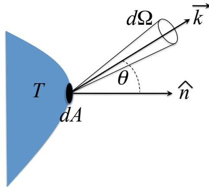
Figura 3: Radiación emitida por una diferencial de área de un cuerpo negro. Note que no puede emitir a ángulos mayores a  $\theta = \frac{\pi}{2}$ .
