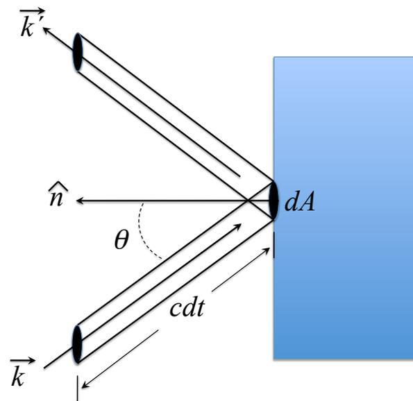
Figura 2: Radiación incide con vector  $\vec{k}$  y es reflejada con vector  $\vec{k}'$ , con  $|\vec{k}| = |\vec{k}'|$ . Existe una transferencia de momento que da lugar a una fuerza de la radiación sobre la pared, y a su vez, a una presión. Note que el ángulo  $\theta$  no puede exceder  $\pi/2$ .
