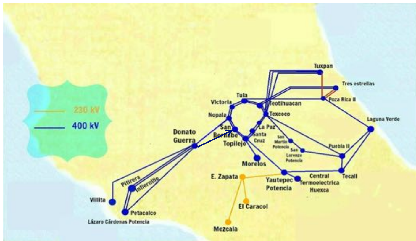
Figura 11. Red eléctrica de potencia en el área central del país y sus interconexiones con las líneas que proveen de energía eléctrica al estado de Morelos en 400 y 230 kV
